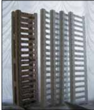
Рис. 7. Решетки ливнеприемников и канализационных систем, которые льют в стопках.
