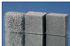
Рис. 1б. Образцы литой пены из нержавеющей стали 316L с размером ячейки 20, 45 и 60 ppi.
